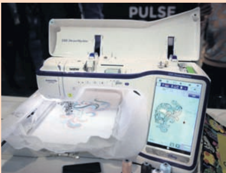
HÁTÆKNISAUMASKAPUR Myndavélar eru ekki einskorðaðar við snjallsíma. Hér getur á að líta saumavél frá Brother sem búið er einni slíkri og skanna að auki. Hægt er að skanna eða mynda munstur og vinna svo með þau á skjá saumavélarinnar. Vélin saumar svo mynstrið þegar það er til reiðu. (Ekki borgar sig þó að bregða sér langt frá því skipta þarf handvirkt um litapræði eftir því hvernig verkinu vindur fram.)
